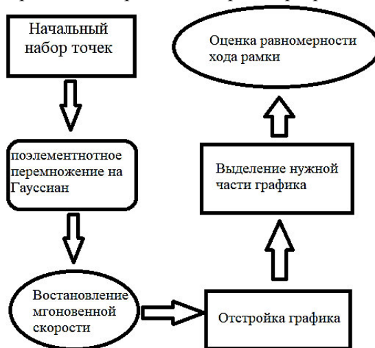
Рис. 2. Алгоритм программы определяющая равномерность хода рамки.
