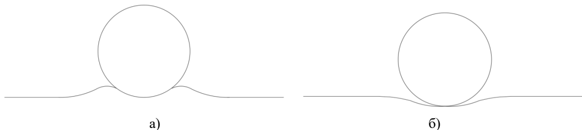
Рис. 1. «Напыл» («pile-up») (а), «Провал» («sink-in») (б).
