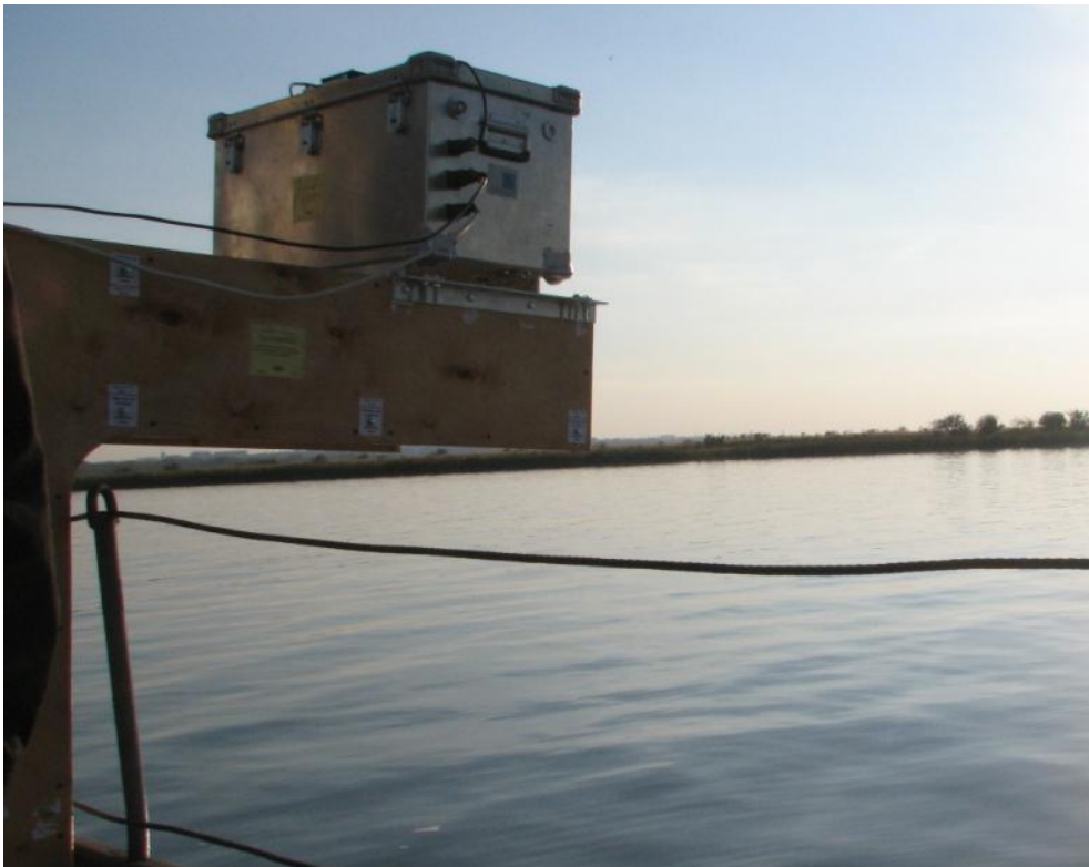
Рис. 2. Двухполяризационный спектрометр для мониторинга водной поверхности с борта судна.
