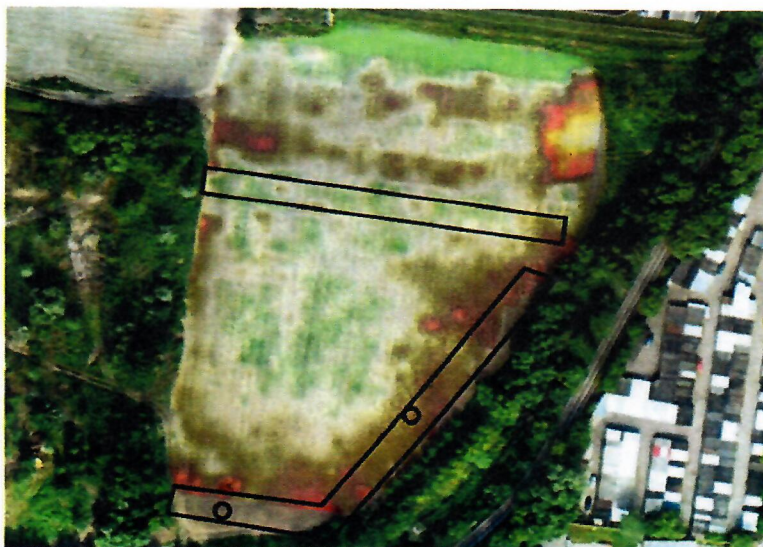
Рис. 4. Горизонтальное сечение волнового изображения, вынесенного на ортофотоснимок
